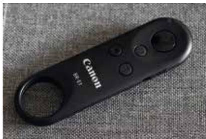
Bluetooth Remote BR-E1 ist eine einfache Fernsteuerung mit den wichtigsten Bedienelementen. Ursprünglich für Selfies entwickelt, kann man inzwischen damit sogar Reihenbilder aufnehmen und auch die Videoaufnahme starten.
