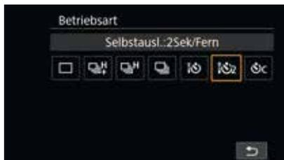
Um den Bluetooth-Fernauslöser verwenden zu können, sollten Sie den entsprechenden Menüpunkt im Kameramenü aktivieren. Im Bild: Bluetoothauslöser mit zwei Sekunden Vorlauf.
